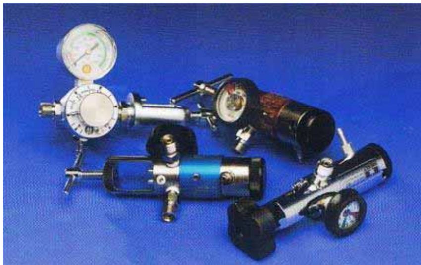
Reduktory do tlenu medycznego mają podobne zastosowanie jak pierwszy stopień automatu nurkowego – zmniejszają i kontrolują ciśnienie z butli
