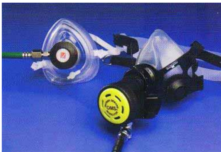
Zawory na żądanie dostarczają 100% tlenu medycznego uszkodzanemu nurkowi, a ponieważ tlen jest zużywany tylko w czasie brania wdechu, powodują one oszczędne zużycie tlenu z butli
