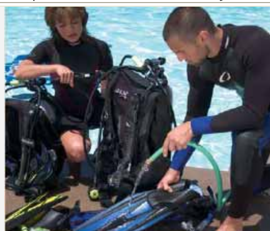
Podstawową dbałością o sprzęt nurkowy jest każdorazowe mycie go słodką wodą po nurkowaniu.
